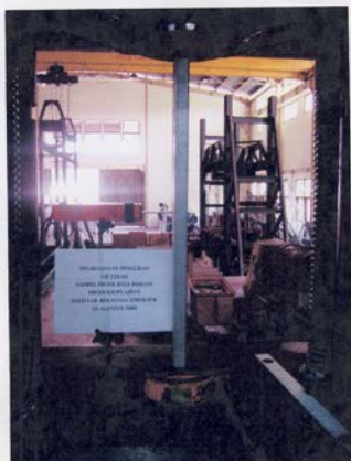
Profil C.75×35×0.75 - sampel 3 (kondisi awal pengujian)
