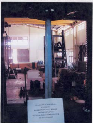
Profil C.75×35×1.0 - sampel 2 (kondisi akhir pengujian)
