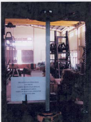
Profil C.75×35×0.75 - sampel 2 (kondisi awal pengujian)
