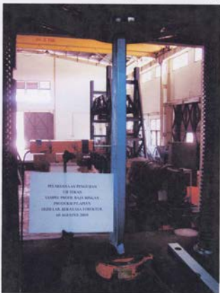
Profil C.75×35×1.0 - sampel 3 (kondisi akhir pengujian)
