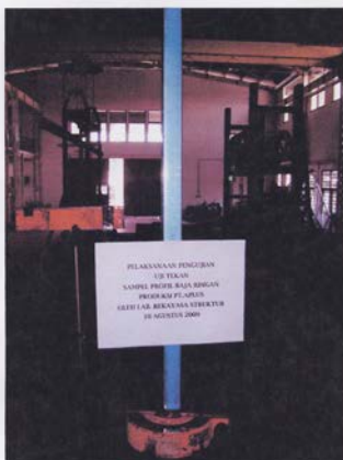
Profil C.75×35×1.0 - sampel 1 (kondisi awal pengujian)
